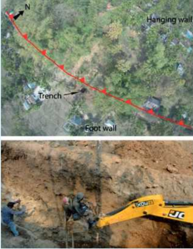
चित्र 77: शीर्ष चित्र फॉल्ट स्कार्प का एक विहंगम दृश्य है, जिसमें स्कार्प के आधार पर एक खोदी हुई खाई दिखाई दे रही है। यह तस्वीर रिको जीआर डिजिटल कैमरे से ली गई थी, जो डीजेआई फीटम 1 मानवरहित हवाई वाहन पर लगा था। नीचे बाएँ भाग में कृषि योग्य समतल भूमि (फुटवॉल) दिखाई दे रही है, और ऊपर दाएँ भाग में ऊपर उठा हुआ फॉल्ट स्कार्प (वन और ग्राम क्षेत्र) (हैंगिंग वॉल) है। नीचे के चित्र में खाई की जमीनी सतह से दीवारों को खुरचते हुए और चारकोल के नमूने एकत्र करते हुए दृश्य को दिखाया गया है।
